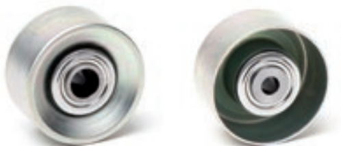
Bild 1: Beispielhaft eine seitens des Fahrzeugherstellers verbaute Umlenkrolle
